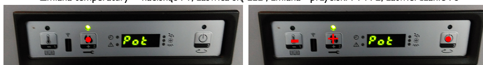
Zmiana mocy urządzenia - nacisnąć P2, nastawy - przyciski P1 i P2, zatwierdzenie P3
